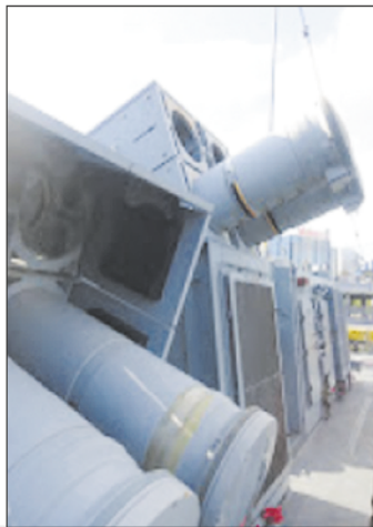
Ракетный катер «Ритсос» (типа «Руссен») и пусковые установки ПКР «Экзосет» (справа)
