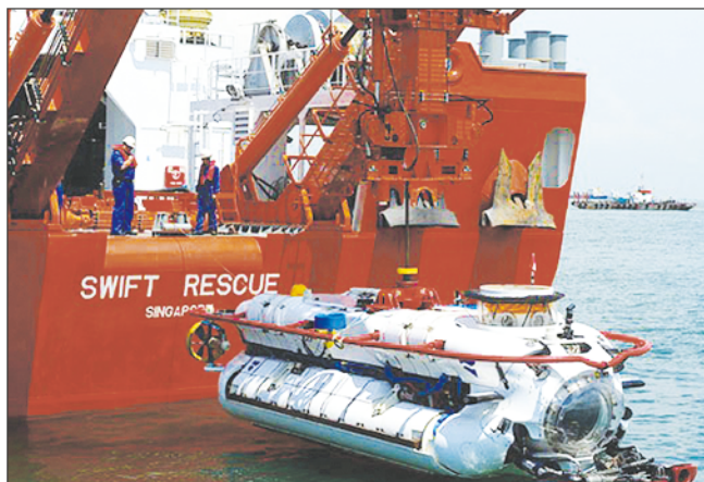
Спасательное судно «Свифт Рескью», на борту которого находится глубоководный поисково-спасательный аппарат DSAR-6
