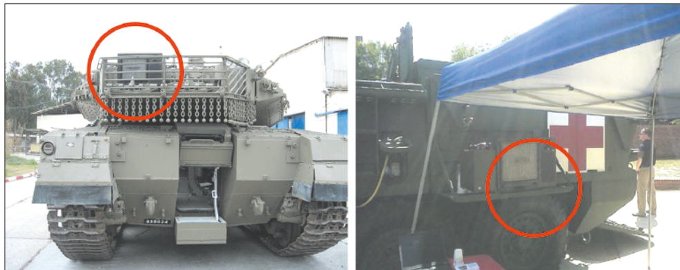
АГПВ GEN-40V, установленный на танке «Меркава» (слева) и на БТР «Страйкер» (справа)
